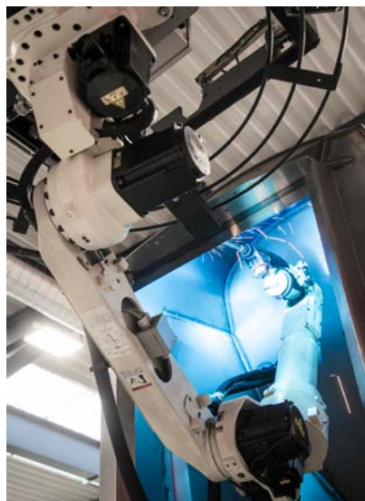
A robotizált hegesztés precíz, egyenletes varratokat készít, konzisztensen magas minőségben.
