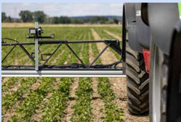
Sávos kijuttatás a HORSCH Leeb LT segítségével: a tengelycsonk kormányzásának vezérlése kamerarendszeren keresztül
