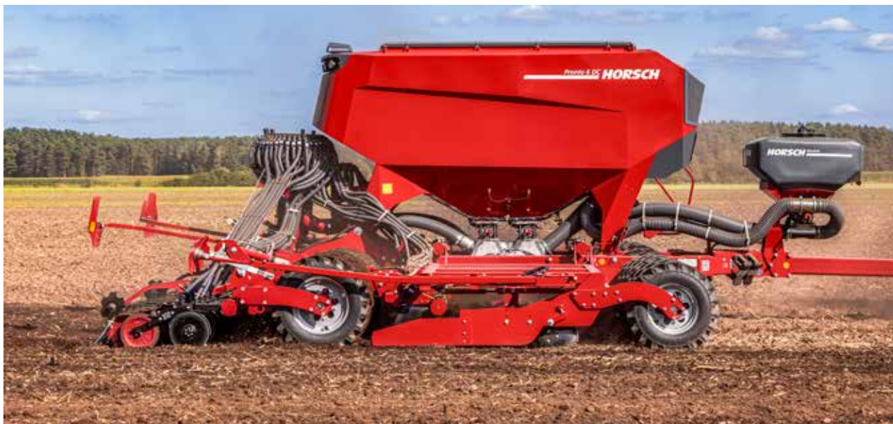
A Pronto kifejelesztésekor a cél az egy menetben megvalósított aprómorzszás talaj létrehozása, tömörítés és visszazárás segítségével elért jobb kelés volt.
