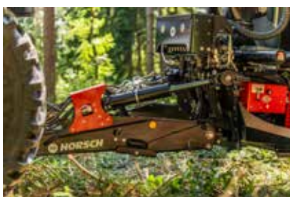
A HORSCH Pirk gépek központi funkciója a hidraulikus beállítású vonórúd.
