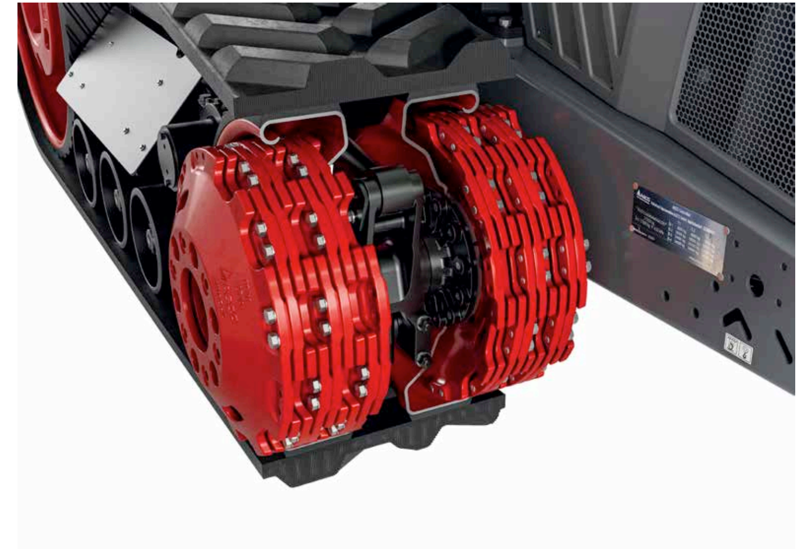
36 vezetőkerék súlya – 9 db minden vezetőkeréken 2041 kg (4500 font)
