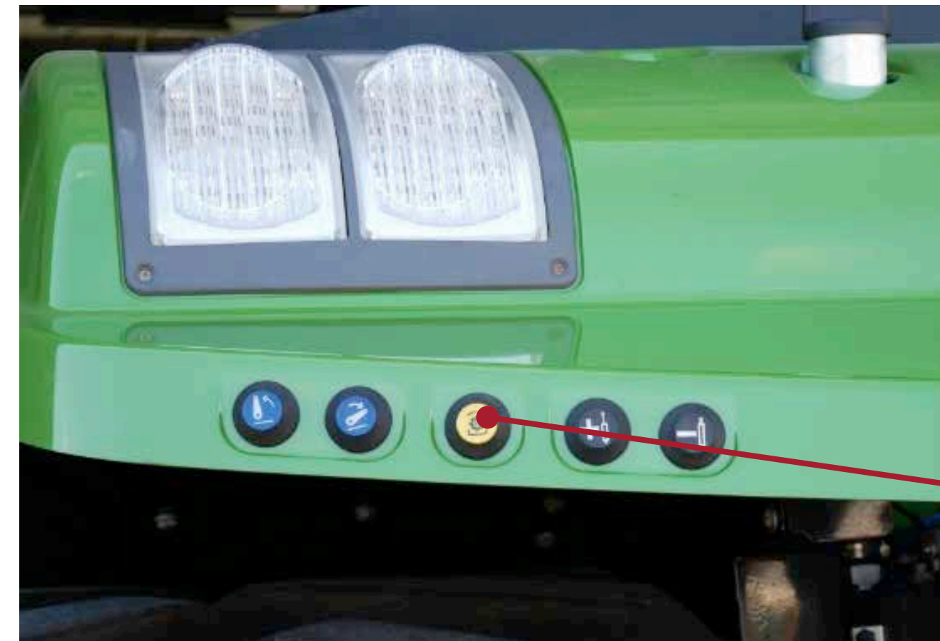
A TLT-automatika aktiválása Hátsó TLT be- és kikapcsolása a joystickon a „Go” és „End” gombokkal
