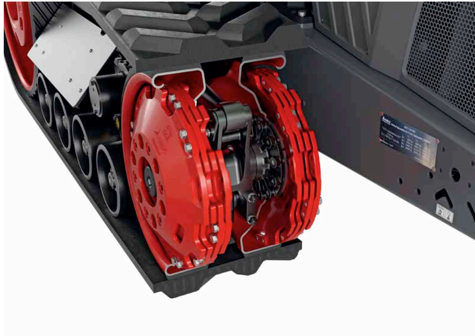
16 vezetőkerék súlya – 4 db minden vezetőkeréken 907 kg (2000 font)
