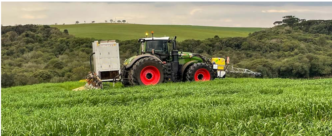
A takarónövények elpusztítását direktvetéshez villamos áram és a vezetőképeség növelésére előzetesen kijuttatott sóoldat kombinációjával Brazíliában tesztelték.
